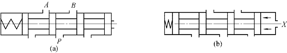
图 5-57 单气控滑阀的动作原理图
